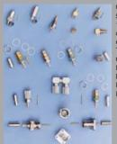
Conectores coaxiales de 50 y 75 $\Omega$  tipos BNC, DIN 1,0/2.3, 1.6/5.6 y otros diseños especiales para enlaces digitales Eo/E1, To/T1, con cables CECBV75-2 y 735-2, Filotex L910/34 y /39, BT3002, T2C-75024, Flex 2, Flex 3, RG-174, RG-175 y RG-179
